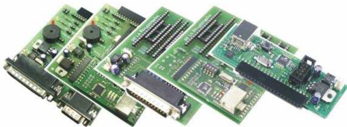
myAVR Board mit LPT- bzw. USB-Port sowie das myMultiProg und der mySmart-Control
